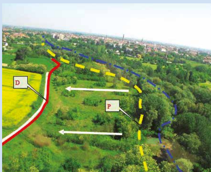
Figura 3 – Esempio di arretramento arginale sul fiume Montone a difesa della città di Forlì. Il fiume Montone è un corso d'acqua che nasce e scorre in Romagna, attraversando dapprima i versanti per poi entrare in pianura interessando le città di Forlì e, più a valle, di Ravenna, punto in cui il Montone riceve il fiume Ronco per poi sfociare nel Mar Adriatico con il nome di Fiumi Uniti. Gli interventi realizzati sul fiume Montone dal locale Genio Civile della Regione Emilia-Romagna, ora Servizio Tecnico di Bacino Romagna, fanno parte di un progetto generale risalente agli anni '90 denominato "Fiumi Puliti", volto alla manutenzione
