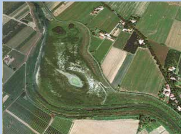
Figura 13 – Esempio di creazione di piana inondabile in un fiume arginato mediante abbassamento del piano campagna di una golena presente lungo il fiume Montone (Comune di Forlì).
