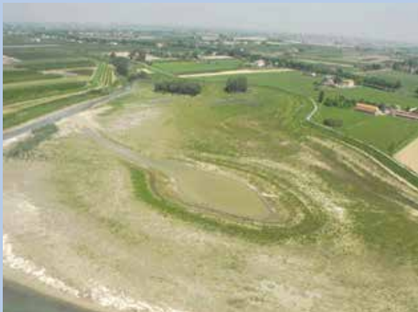
Figura 13 – Esempio di creazione di piana inondabile in un fiume arginato mediante abbassamento del piano campagna di una golena presente lungo il fiume Montone (Comune di Forlì).
