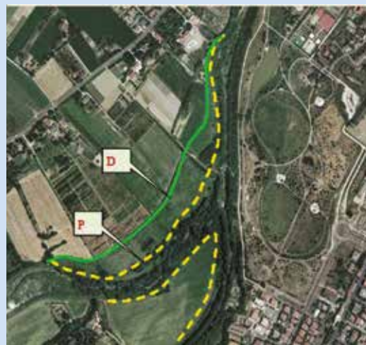
Figura 3 – Esempio di arretramento arginale sul fiume Montone a difesa della città di Forlì. Il fiume Montone è un corso d'acqua che nasce e scorre in Romagna, attraversando dapprima i versanti per poi entrare in pianura interessando le città di Forlì e, più a valle, di Ravenna, punto in cui il Montone riceve il fiume Ronco per poi sfociare nel Mar Adriatico con il nome di Fiumi Uniti. Gli interventi realizzati sul fiume Montone dal locale Genio Civile della Regione Emilia-Romagna, ora Servizio Tecnico di Bacino Romagna, fanno parte di un progetto generale risalente agli anni '90 denominato "Fiumi Puliti", volto alla manutenzione
